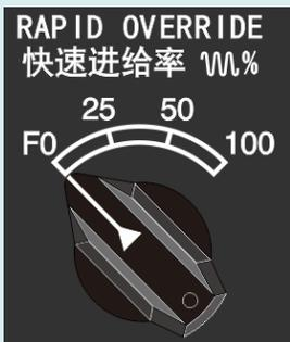
快速进给速率倍率旋钮，用来调整快送 (G00) 以及手动快速移动 (RAPID) 的进给速率。
