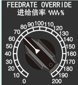
进给速率倍率选择旋钮，用来调整切削 (G01/G02/G03)、手动进给 (JOG) 速率。
