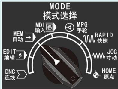
这开关是用以选择系统操作模式，共分8种模式，有手动资料输入模式(MDI)、记忆模式(MEM.EDIT)、DNC模式(DNC)、手轮模式(MPG)、手动寸动连续进给(JOG)、手动快速连续进给(RAPID)、原点复归模式(ZRN)等。
